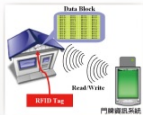
▲ 圖 2 RFID 資訊門牌系統
